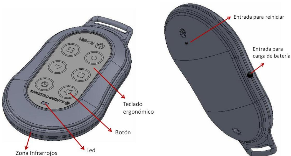
Figura 1: Mando Control 6. Vista 3D y lateral
