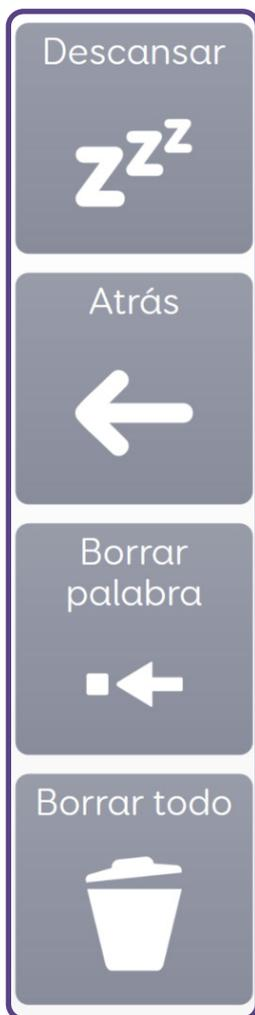
En el caso de que uses un método de acceso alternativo, como el control con la mirada o el ratón de cabeza, y clic por espera para seleccionar, también verás en la parte superior de esta columna una **celda de descanso** que puedes usar para pausar tu método de acceso. Esta columna de función se puede encontrar en todas las cuadrículas de Voco Chat.
