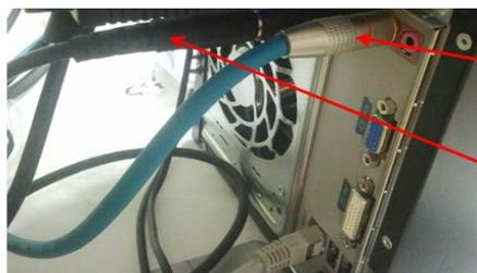
Cable jack conectado con el adaptador reductor de jack en la entrada de micrófono del PC (conector rojo)
