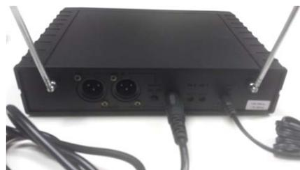
cable jack conectado en la salida de línea del kit de voz
