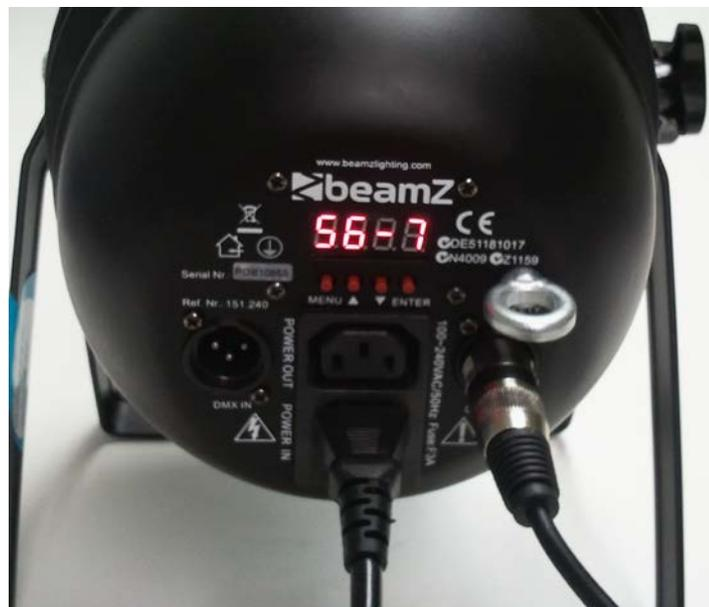
Ejemplo de configuración del foco en modo S6 a velocidad 7
