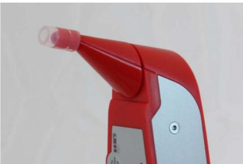
Figura 8: Colocación correcta del tubo de silicona.
