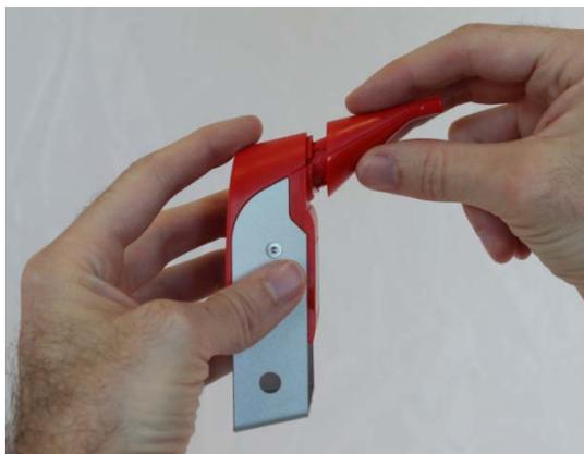
Figura 10: Extracción de la pieza de boca
