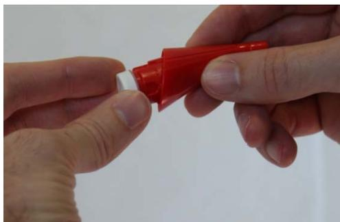
Figura 13: Encaje de la membrana
