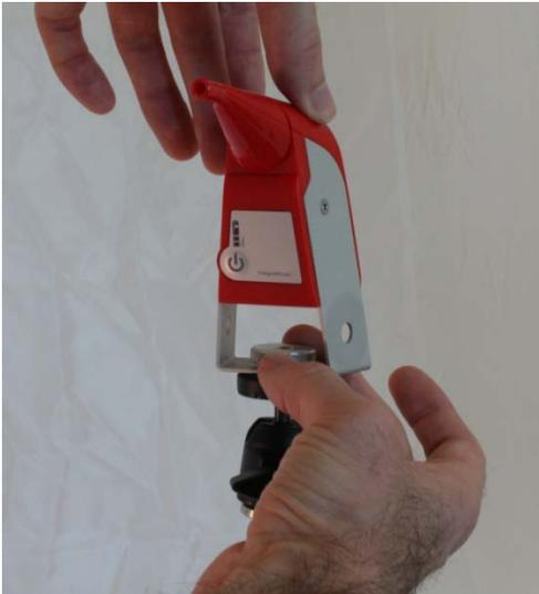
Figura 7: Montaje de IntegraMouse Plus
